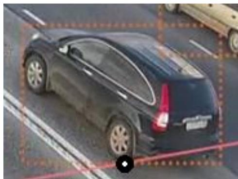
Рисунок 158 – Пересечение линии подсчета с точкой подсчета
