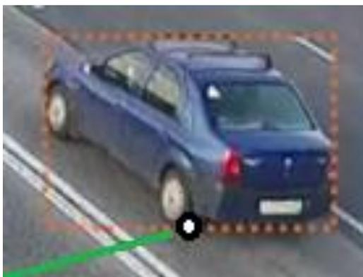
Рисунок 159 – Отсутствие пересечения линии подсчета с точкой подсчета
